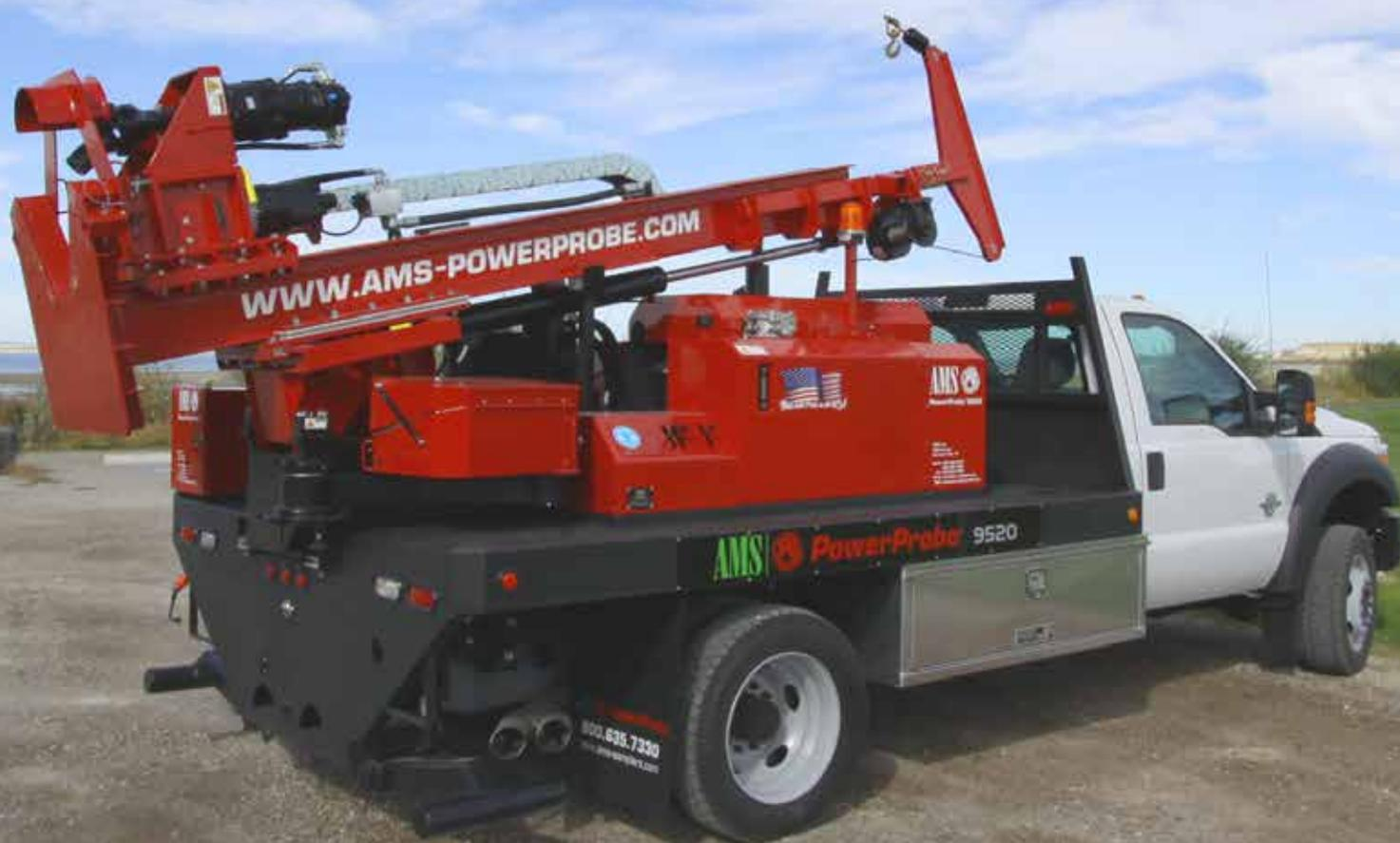
9520-D дизель работает от дизельного двигателя с системой охлаждения и турбонаддувом мощностью 60 л.с.. В стандартную комплектацию входит гидравлический молот 474 Н·м (350 фунт-фунтов), отбор проб грунтовых вод и газа, восстановительного закачивания. Установка оборудована буром мощностью 4000 Н·м (3,000 фут-фунтов) и лебедкой грузоподъемностью 1,36 тонны. Ход цилиндра, перемещающего буровую головку 200 см и позволяет использовать 150 сантиметровые инструменты.
