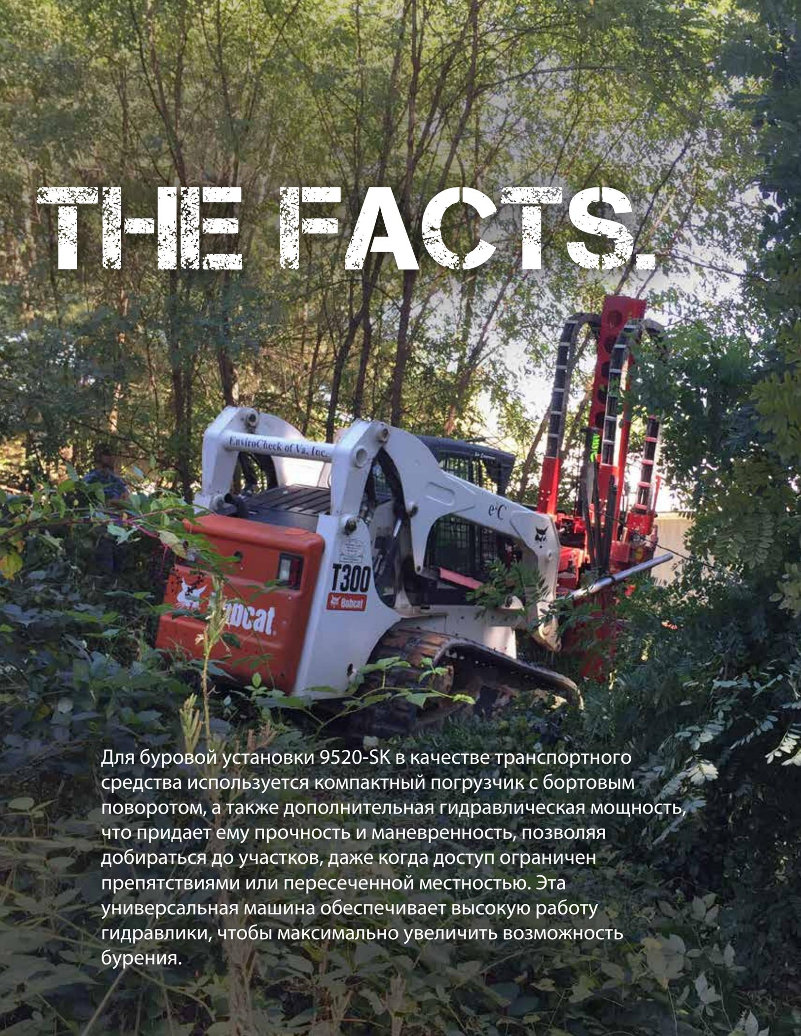
Для буровой установки 9520-SK в качестве транспортного средства используется компактный погрузчик с бортовым поворотом, а также дополнительная гидравлическая мощность, что придает ему прочность и маневренность, позволяя добираться до участков, даже когда доступ ограничен препятствиями или пересеченной местностью. Эта универсальная машина обеспечивает высокую работу гидравлики, чтобы максимально увеличить возможность бурения.
